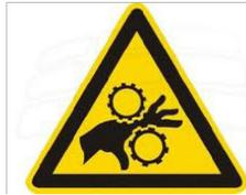
Achtung! Führen Sie keine Wartungsarbeiten an der Trommelabdeckung durch. Ziehen Sie den Stecker aus der Steckdose und stellen Sie sicher, dass der Filter nicht eingeschaltet werden kann. Um Verletzungen zu vermeiden, achten Sie darauf, dass Ihre Hände oder Finger die rotierenden Teile des Filters nicht erreichen können, wenn dieser an das Stromnetz angeschlossen ist.
