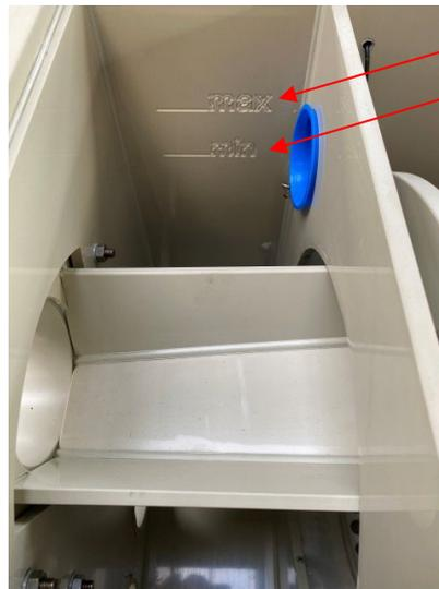
Maximaler und minimaler Teichwasserstand Im Schwerkraft-Setup.
