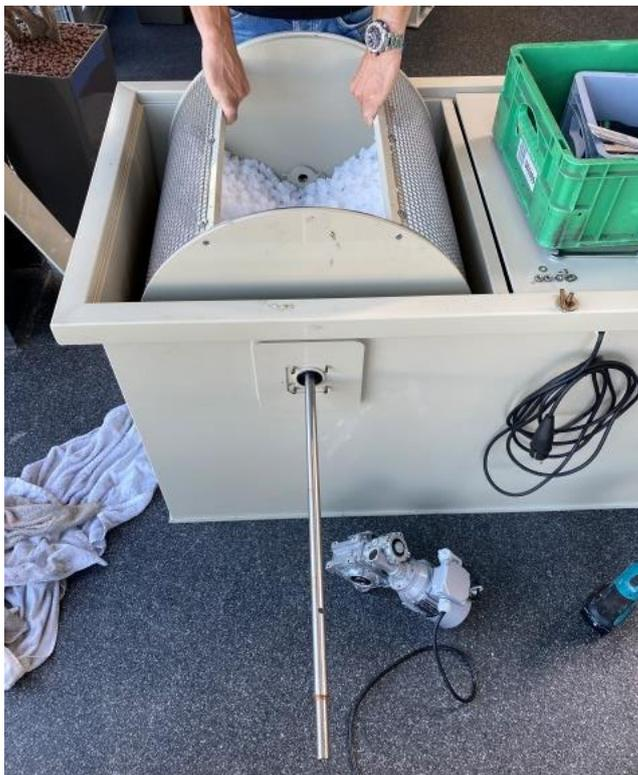
Entfernen Sie die Achse mit 2 Mann.
