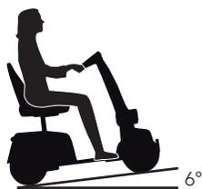
Angle d'inclinaison maximal
