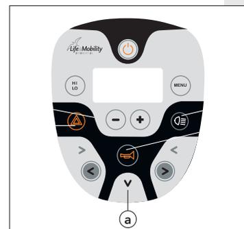
De snelheidsindicator staat standaard op 4 blokjes, dit is 40% van het totale vermogen. De maximale snelheid is 12 km/u. Uw leverancier heeft de mogelijkheid om de snelheidsinstelling aan te passen.
