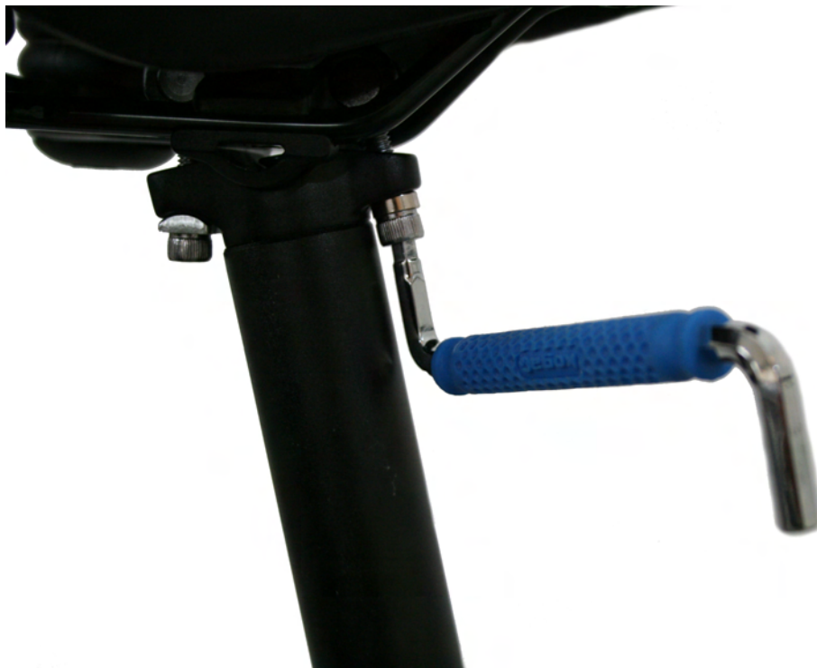
Figuur 2: Horizontale zadelfverstelling
