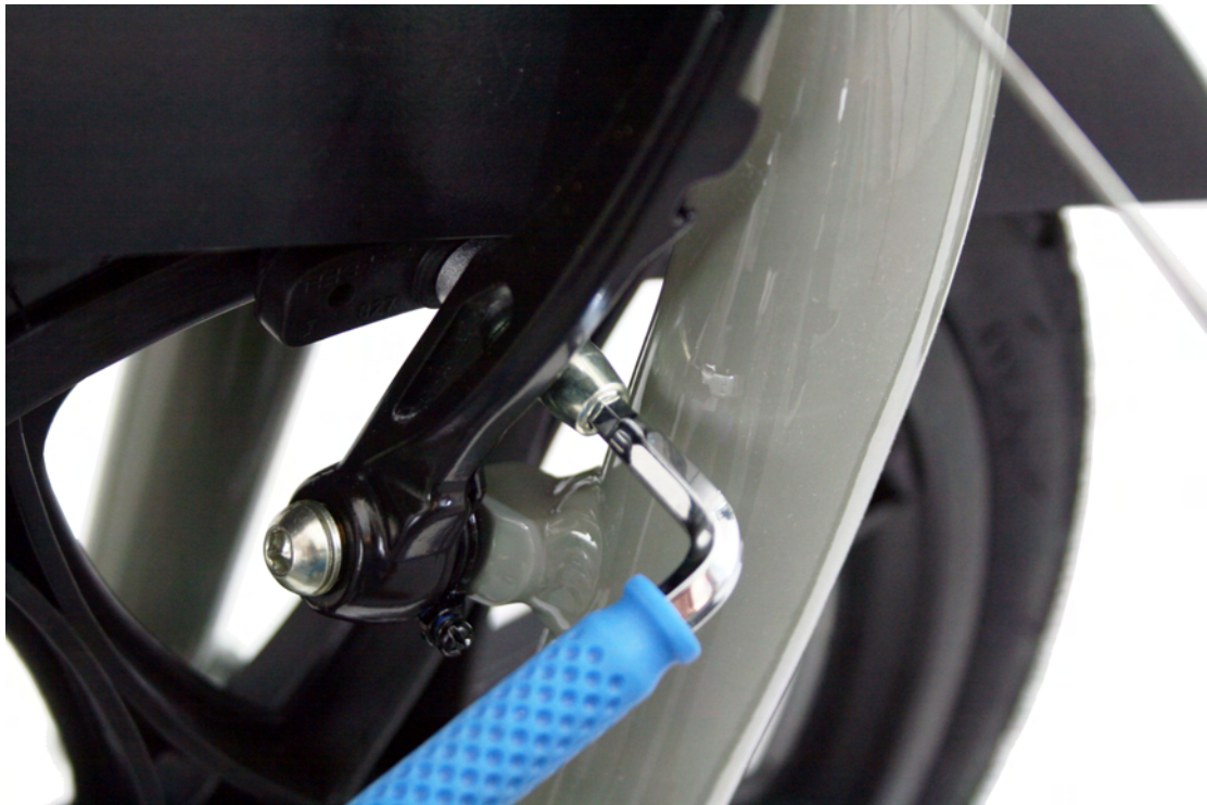
Figuur 11: Remblokken afstellen
