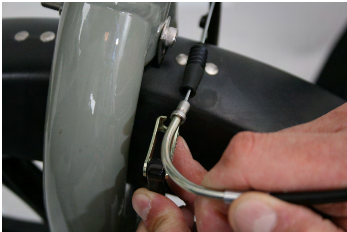
Figuur 10: Remkabel monteren
