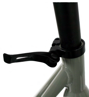
Figuur 4: Open de snelsluis
