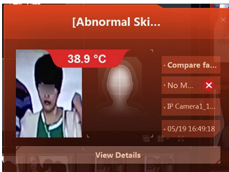
Figura 12-17 Ventana emergente de alarma
