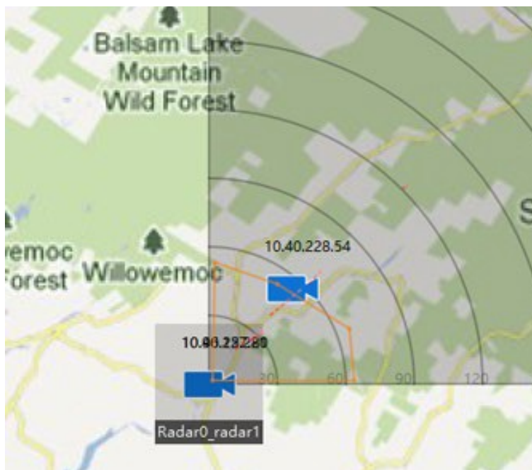
Figura 9-31 Campo de visión de la cámara PTZ
