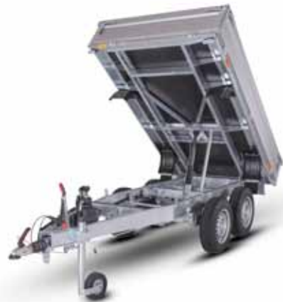
Anhänger Delta B2 mit manueller Pumpe
