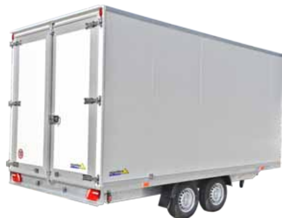
Doppelflügeltür mit Drehstangenverschluss
