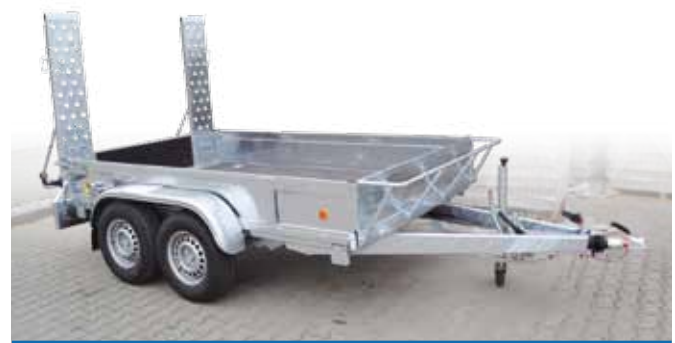
Hinten integrierte Stahl-Auffahrschienen mit hoher Tragfähigkeit
