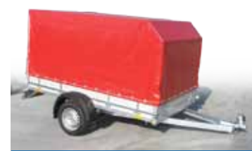
Möglichkeit des Aufbaus der Bordwände und Plane mit Gestell bei KANGAROO 12 und 15
