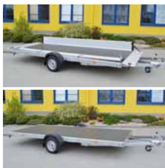
einfache Demontage der Bordwände, Ausführung Plateau
