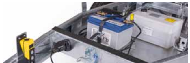
Elektrische Hydraulik mit Batterie
