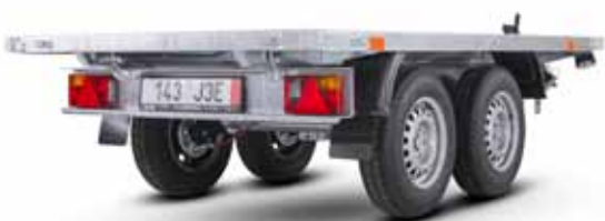
Abnehmbare Eckpfosten und Bordwände
