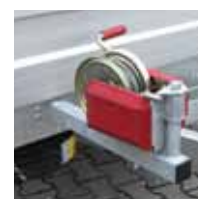
Abnehmbare manuelle Seilwinde mit Halter
