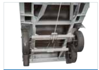
Massive ganzgeschweißte Konstruktion des Anhängers
