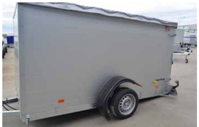
Absenkanhänger mit Alukoffer und Schiebeplanendach
