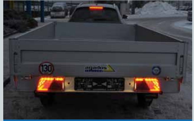
Blinklichter mit dynamischer Funktion
