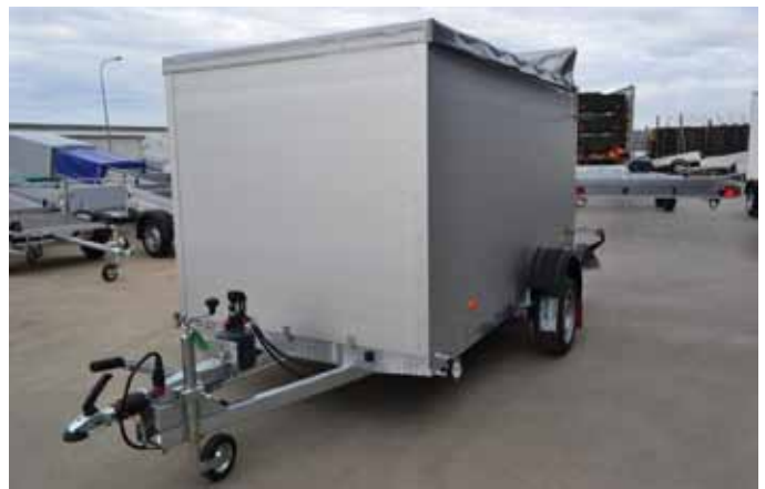
Absenkanhänger mit Alukoffer und Schiebeplanendach
