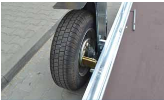
Hydraulisch absenkbare Achse
