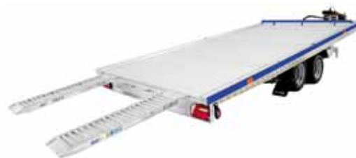
ALU Rampen ausziehbar, in Breite verstellbar
