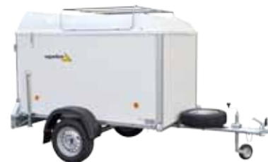
Anhänger VZ 21 O mit Reserverad, Stützfüßen und Glasfaserdeckel (GFK)
