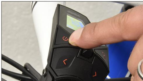
**SEULEMENT POUR MODELES PRODUITS AVANT 2019** - Pour arrêter le système, il faut d'abord éteindre l'écran et ensuite la batterie. Si vous arrêtez seulement l'écran, la batterie restera en fonction pendant deux heures avec une consommation minimum de la batterie.
