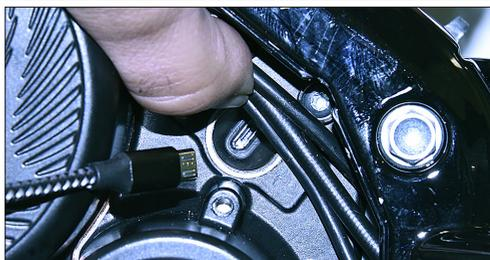
Les firmwares mis à jour sont disponibles sur le site [www.polinibike.com](http://www.polinibike.com). En plus du firmware, il est possible (avec le câble connecté au moteur) de télécharger un logiciel permettant de modifier le côté de montage du cyclo-ordinateur droit ou gauche et, en cas de variations de la mesure du pneu, d'étalonner la détection de la vitesse.
