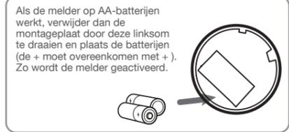
OPMERKING: Bij melders van het type FA6120, moet u de melder op de montageplaat installeren om de melder te activeren. Bij melders van het type FA6111, FA6115 en FA6215, wordt de melder geactiveerd door de batterijen te plaatsen.
