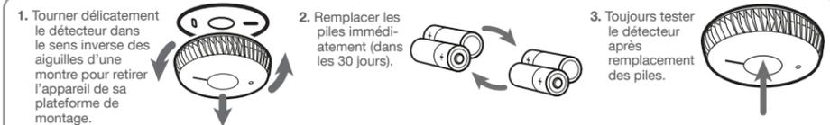
Les détecteurs FA6111, FA6115 et FA6215 requièrent 2 piles AA. Au cours d'une utilisation standard, les piles ont une durée de vie d'environ trois ans pour le modèle FA6111 et cinq ans pour les modèles FA6115 et FA6215. Utiliser des piles autres que celles recommandées ici pourrait avoir un effet néfaste sur le détecteur : Duracell AA MN1500 Alcaline, GP AA GN15A Alcaline, Energizer AA L91 Lithium.
