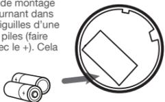
NOTE : pour le modèle FA6120, le détecteur doit être installé sur sa plateforme de montage afin de pouvoir déclencher une alerte. Pour les modèles FA6111, FA6115 et FA6215, l'installation des piles active le détecteur.
