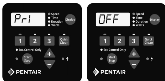
Figure 11 : Désactivation de l'amorçage
