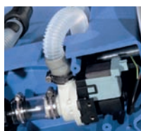
voorzien van afvoerpomp
