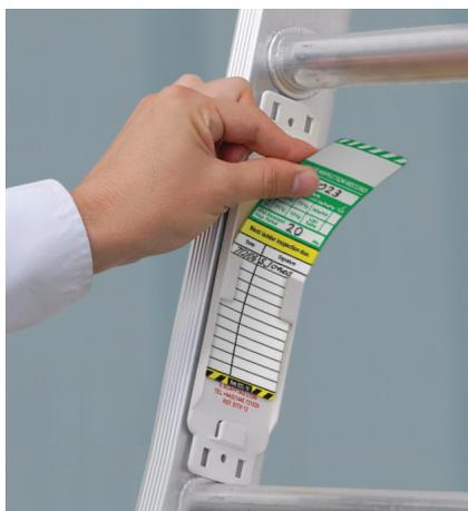
Der Laddertag-Halter wird an der Leiter angebracht. Es wird empfohlen, den Laddertag-Halter zwischen der vierten und fünften Sprosse auf der Innenseite der Leiter zu befestigen, damit er sofort sichtbar ist, den Bediener aber nicht stört. Vor der ersten Verwendung zeigt der Halter das Verbotssymbol mit dem Hinweis „Diese Leiter nicht benutzen“ deutlich an.
