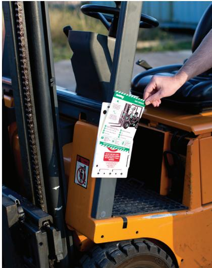
Der Forkliftag-Halter wird mit Kabelbindern oder Klebstoff in der Kabine des Gabelstaplers an einer Stelle angebracht, an der er deutlich sichtbar ist, die Bediener aber nicht stört. Vor Schichtbeginn führt der Bediener die Prüfungen durch, die auf der Checkliste auf dem Forkliftag-Einsteckschild angegeben sind.
