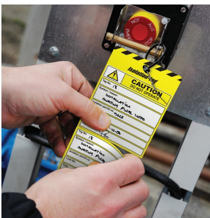
Der Isolation Tag wird mit Kabelbindern am Gerät angebracht. Der Anhänger ist perforiert, damit ein Teil am Gerät angebracht werden kann, während der andere Teil bei der zuständigen Person verbleibt. So ist der aktuelle Betriebsstatus für alle Mitarbeiter klar ersichtlich. Dank der Perforierung kann jeder Teil des Anhängers ganz einfach ohne Verwendung einer Schere oder eines Messers entfernt werden, was möglicherweise eine zusätzliche Genehmigung erfordern würde.
