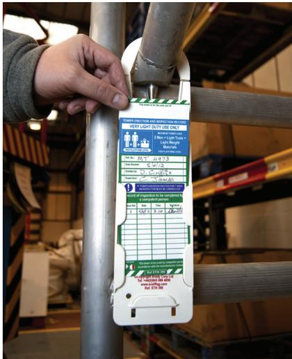
Der Tower Tag-Halter wird mit Kabelbindern oder der flexiblen Schlaufe des Tower Tag-Halters am mobilen Turm oder Mast angebracht. Der Halter sollte in der Nähe des Zutrittspunkts oder an einer anderen Stelle angebracht werden, wo er deutlich sichtbar ist. Auf dem leeren Tower Tag-Halter wird das Verbotssymbol mit dem Hinweis „Turm nicht verwenden“ deutlich angezeigt.
