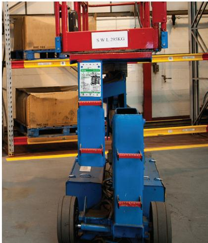
Der MEWP Tag-Halter wird mit Kabelbindern oder Klebstoff in der Nähe der Bedienerkabine oder des Zugangspunkts an einer Stelle angebracht, an der er deutlich sichtbar ist, die Bediener der Hubarbeitsbühne aber nicht stört. Vor Schichtbeginn führt der Bediener die Prüfungen durch, die auf der Checkliste auf dem MEWP Tag-Einsteckschild angegeben sind.
