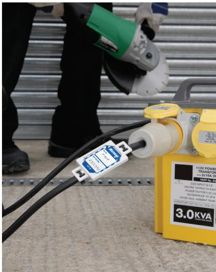
Der Microtag-Halter wird mit Kabelbindern oder Klebstoff an einer Stelle am Gerät angebracht, an der er deutlich sichtbar ist, die Bediener aber nicht stört. Achten Sie darauf, dass das Verbotssymbol mit dem Hinweis „Dieses Gerät nicht verwenden“ vor der Prüfung deutlich sichtbar ist.
