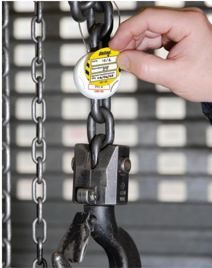
Der Unitag-Halter wird mit der Unitag-Schlinge an einer Stelle am Gerät angebracht, an der er deutlich sichtbar ist, die Bediener aber nicht stört. Achten Sie darauf, dass das Verbotssymbol mit dem Hinweis „Nicht verwenden“ vor der Prüfung deutlich sichtbar ist.
