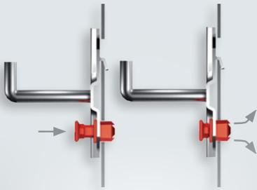
ABAX® verbindet werkzeuglos und sekundschnell die Werkzeughalter mit allen Produkten von Kappes mit ®RasterPlan Systemlochung.
