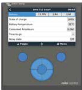
Color Control De krachtige Linux-computer, verborgen achter het kleurendisplay en de knoppen, verzamelt gegevens van alle Victron-apparatuur en geeft deze weer op het display. Behalve met Victron-apparatuur communiceert de Color Control via CAN-bus (NMEA2000), Ethernet en USB. De gegevens kunnen op het VRM Portal worden opgeslagen en geanalyseerd.
