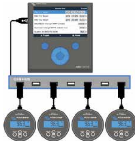
Maximaal kunnen vier BMV's direct op de Color Control worden aangesloten. Voor centrale bewaking kunnen nog meer BMV's kunnen via een USB-hub worden aangesloten.
