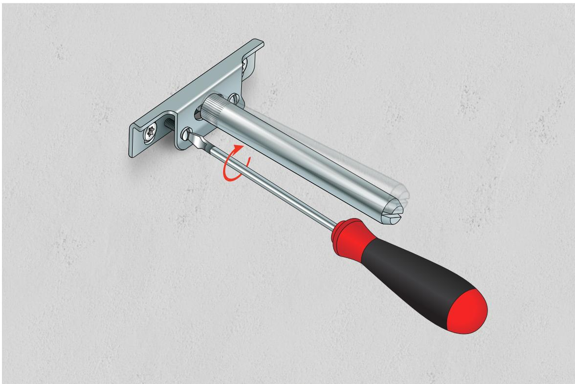
6. **Überprüfen Sie die Halterungen:** Stellen Sie sicher, dass die Halterungen fest befestigt und vollständig waagrecht ausgerichtet sind.
