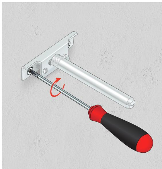
4. **Seiteneinstellung:** Lösen Sie den Träger (Stange) und schieben Sie ihn durch den Schlitz, um ihn nach links oder rechts zu verstellen. Ziehen Sie anschließend die Vierkantsmutter wieder fest, sobald sich der Träger in der gewünschten Position befindet.
