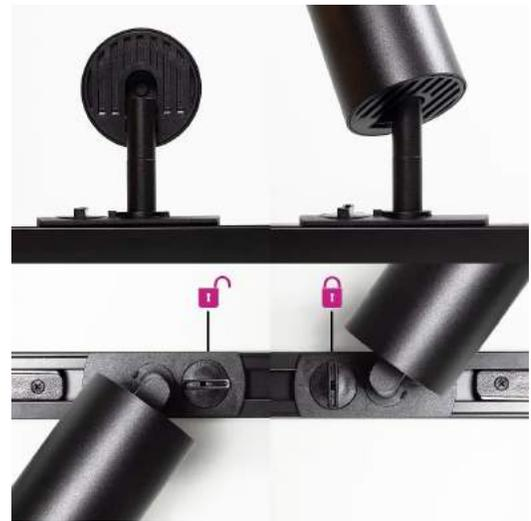
Remarque : l'adaptateur ne s'insère dans le rail que d'une seule manière. Le rail est en effet doté d'un petit rebord sur le côté. Ci-dessous, vous pouvez voir la bonne façon de connecter le spot. Si le spot n'est pas connecté correctement, il n'entrera pas en contact avec le rail.
