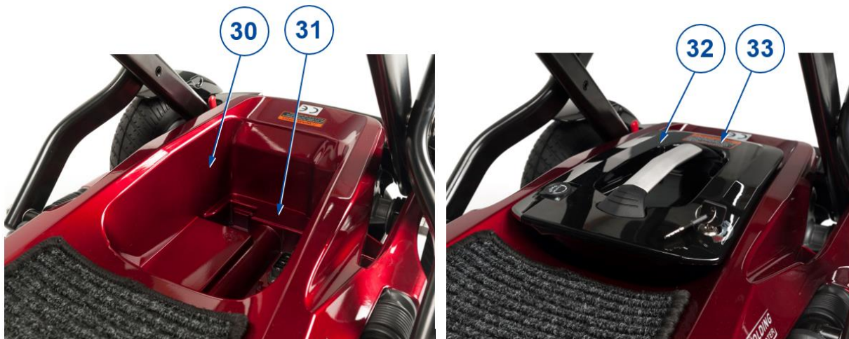
Figura 4 Batería y ubicación de la placa de identificación
