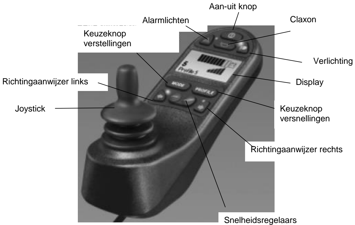
Figuur 4: de bedieningskast
