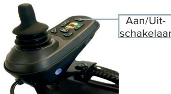
13. Schakel na gebruik uit en verwijder de accu als u de rolstoel langer dan 48 uur niet gebruikt. Vouw de rolstoel eenvoudig op door de vouwklem los te maken en weg te houden, en de rugleuning voorwaarts te duwen. Zet de rolstoel rechtop en berg hem in een geschikte locatie op.
