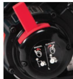
Assurez-vous que le fauteuil roulant électrique est à l'arrêt et qu'il est en mode « Electric » (électrique) avant de connecter le chargeur (voir page précédente).
