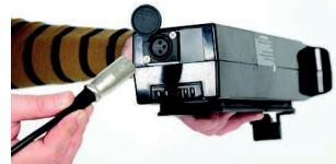
12. Zorg ervoor dat de oplader voor gebruik is verwijderd en schakel de elektrische rolstoel in.
