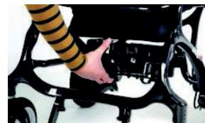
8. Pour remettre en place la batterie, glissez-la sur les rails de support et poussez fermement jusqu'au «clic».
