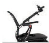
Installeer de joystick aan de kant die de voorkeur heeft, draai vervolgens de bevestigingsknop los en steek de slang van de joystick erin. Nadat de gewenste stand is bereikt, schroeft u de bevestigingsschroef er weer in. Verbind de 2 polen en zorg ervoor dat de uiteinden op hun plaats vergrendeld zijn.
