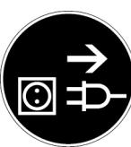
Let op! Voor montage, reiniging, ombouw, instandhouding, opslag en transport moet u het apparaat uitschakelen en loskoppelen van de stroomvoorziening.
