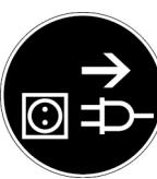
Uwaga! Przed przystąpieniem do instalacji, czyszczenia, zmiany, konserwacji, przechowywanie i transport przy użyciu urządzenia i odłączyć go od sieci.
