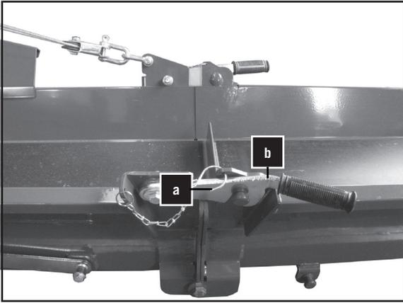
1. Transportband mit der Seilwinde auf den Boden absenken. Sicherungshaken (a) entfernen und beidseitig die Sperrriegel (b) am Transportband öffnen.
