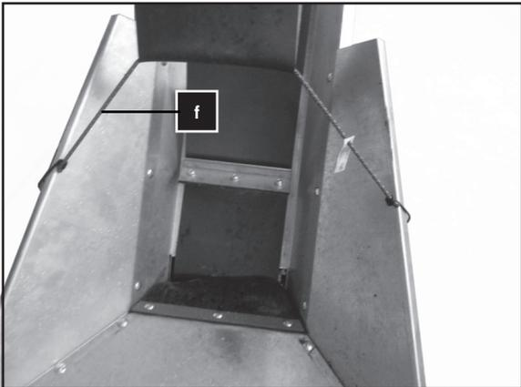
7. Haltegummi (f) des Förderbandes aushängen und in die Halteöse (e) der Kette mit einhängen.
