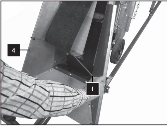
7. Haltegummi (f) durch das Band ziehen und rechts und links am Einfülltrichter (4) einhängen.
