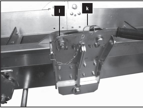
11. Sichern Sie beide Seiten mit den Sicherungshaken (k).
