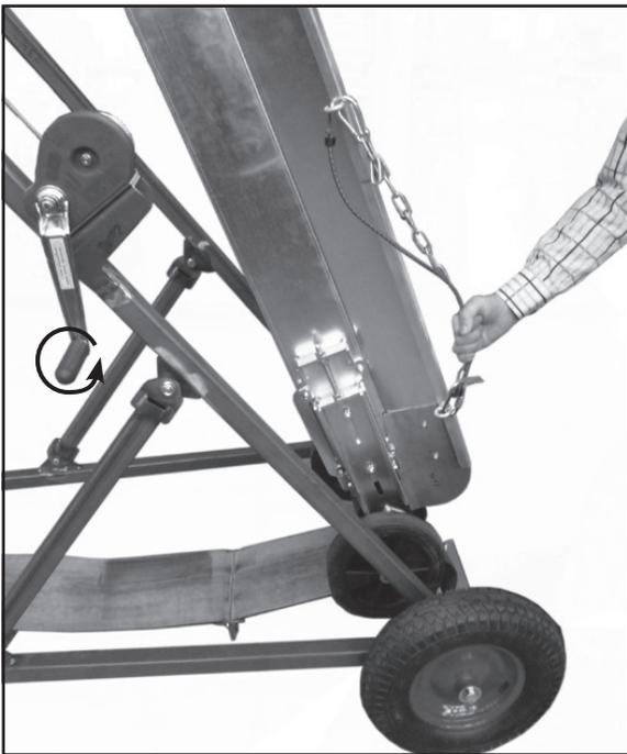
9. Förderband mit der Seilwinde absenken, gleichzeitig von Hand über die Achse schwenken bis die Räder den Boden berühren.
