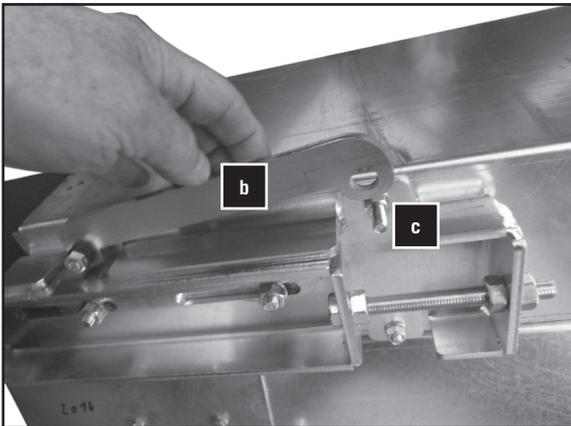
3. Haltebügel (b) abklappen und auf der Schraube (c) einhängen.
