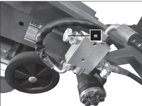
2. Bei Hydraulischem Antrieb kann mittels der Stellschraube (m) die Geschwindigkeit verstellt werden.
