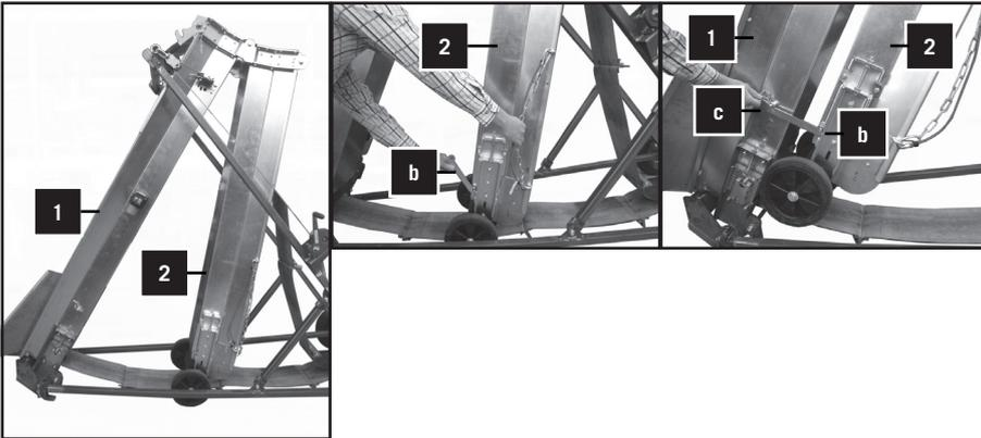
2. Transportband mit der Seilwinde bis zum Ende hochkurbeln.
