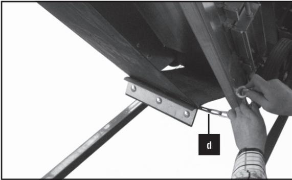
8. Haltekette (d) aushängen, unter dem Band durchziehen und auf der anderen Seite in die Halteöse einhängen.
