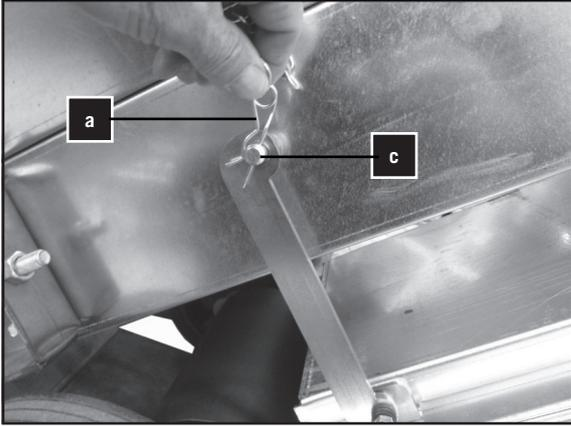
1. Sicherungsstecker (a) vom Haltebolzen (c) entfernen.
