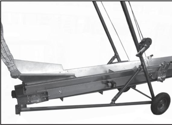
13. Durch anheben am Trichter kann das Förderband von Hand transportiert werden.
