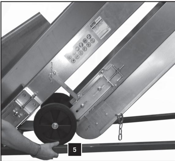
9. Zum Transport Transportband neigen bis Räder mit Unterkante Fahrwerk eben sind (5)
