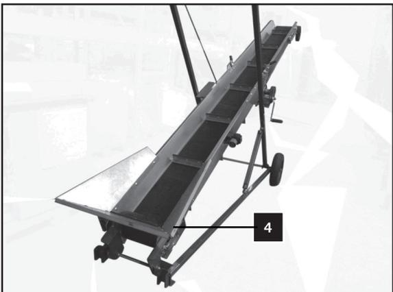
4. Montieren Sie den Einfülltrichter (4) an die richtige Position am Förderband.
