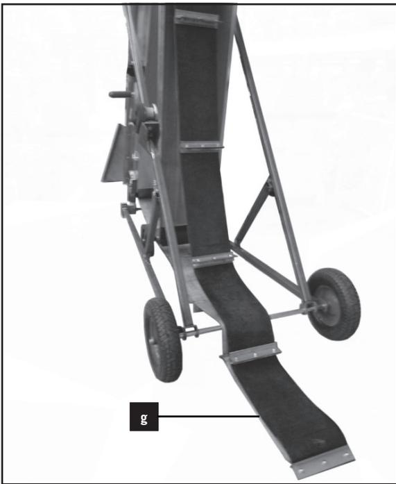
8. Ziehen Sie nun das Band (g) über die Achse und legen es gerade auf dem Boden aus.
