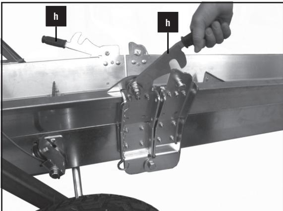
10. Senken Sie mittels der Seilwinde das Förderband soweit ab, bis es auf der Radachse aufliegt. Klappen Sie beide Riegel (h) nach vorne bis Sie auf den Haltebolzen aufliegen. Heben Sie das obere Teil des Bandes an, bis beide Riegel einrasten, und drücken Sie dann die Riegel zum vollständigen einrasten fest nach unten.
