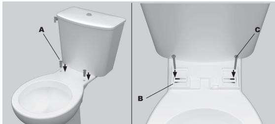
✓ Der Klick-Adapter muss die korrekte Positionierung des Toilettensitzes ermöglichen.
