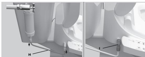
Brancher le raccord rapide coudé sur l'entrée d'eau du réservoir de l'abattant.
