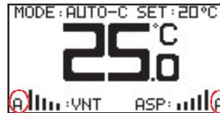
Der 0-10V-Luftqualitäts- oder CO<sub>2</sub>-Sensor muss korrekt angeschlossen werden. Dann muss Heizen, Kühlen oder Automatik als Betriebsmodus eingestellt werden und die Ventilator Drehzahl auf Automatik gestellt werden. Wenn diese Bedingungen erfüllt sind, wird die Ventilator Drehzahl automatisch gemäß dem Sensorwert angepasst.
