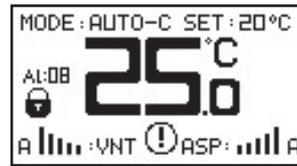
Wenn der Kontakt in geschlossener Position steht, erfolgt ein Luftfilter-Alarm. **AL:08** wird auf dem Bildschirm angezeigt und das Gerät läuft während des Alarms normal weiter. Der Kontakt muss in offener Position stehen, um den Alarm abzuschalten.
