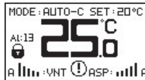
Dieser Alarm erfolgt, wenn - es im Szenario einen Zuluft-Temperatursensor gibt und dieser Sensor nicht an die Inputs der Steuerplatine angeschlossen ist
