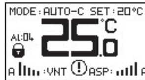
Wenn der Kontakt in offener Position steht, erfolgt ein Heizungskontaktalarm. Die Outputs der Heizung werden deaktiviert. Die Ventilatoren laufen bei maximaler Drehzahl, um die elektrische Heizung vor Überhitzung
