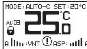
Wenn der Kontakt in offener Position steht, erfolgt ein Ventilator-Kontaktalarm.
