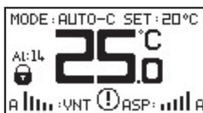
Dieser Alarm erfolgt, wenn - es im Szenario einen Abluft-Temperatursensor gibt und der Sensor nicht an die Inputs der Steuerplatine angeschlossen ist
