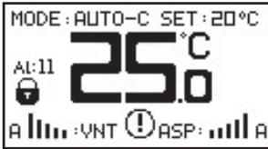
Dieser Alarm erfolgt, wenn - es im Szenario einen Außen- oder Frischluft-Temperatursensor gibt und dieser Sensor nicht an die Inputs der Steuerplatine angeschlossen ist
