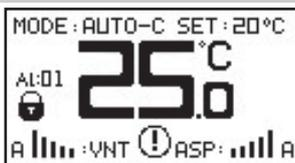
Wenn der Kontakt in offener Position steht, erfolgt ein Notfall-Kontaktalarm. Das Gerät schaltet sich während des Alarms ab. **AL:01** wird auf dem Bildschirm angezeigt und
