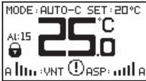
Dieser Alarm erfolgt, wenn - die Temperatur des Wärmetauschers  $< (-5\text{ °C})$  beträgt. Der Zuluftventilator läuft auf Stufe 1, der Abluftventilator läuft auf höchster Stufe. Das Raum-Panel ist gesperrt. Wenn
