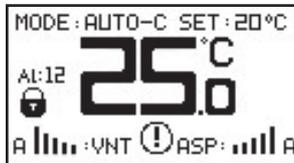
Dieser Alarm erfolgt, wenn - es im Szenario einen Wärmetauscher-Temperatursensor gibt und dieser Sensor nicht an die Inputs der Steuerplatine angeschlossen ist
