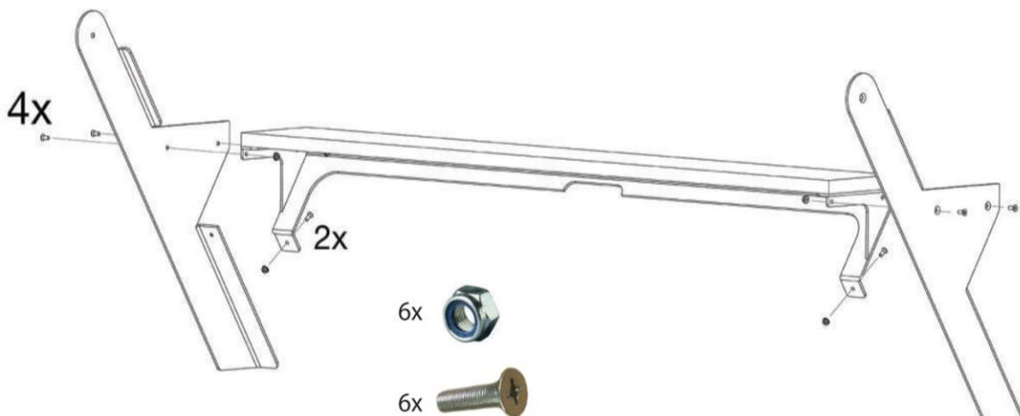
Richten Sie die Löcher genau aus und befestigen Sie die Vorderbank mit sechs Schrauben an den Vorderbeinen. Verwenden Sie dazu **sechs mittelgroße Schrauben und Muttern (M6 x 16 mm)**.
