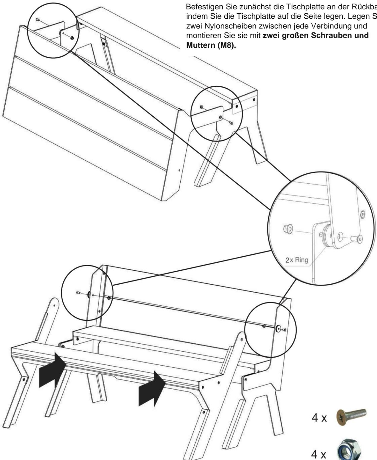
Klappen Sie die Tischplatte als Rückenlehne um und schieben Sie den Vordersitz auf den Rücksitz. Verwenden Sie wiederum zwei Nylonscheiben an jeder Verbindung und montieren Sie sie mit **zwei großen Schrauben und Muttern (M8)**.
