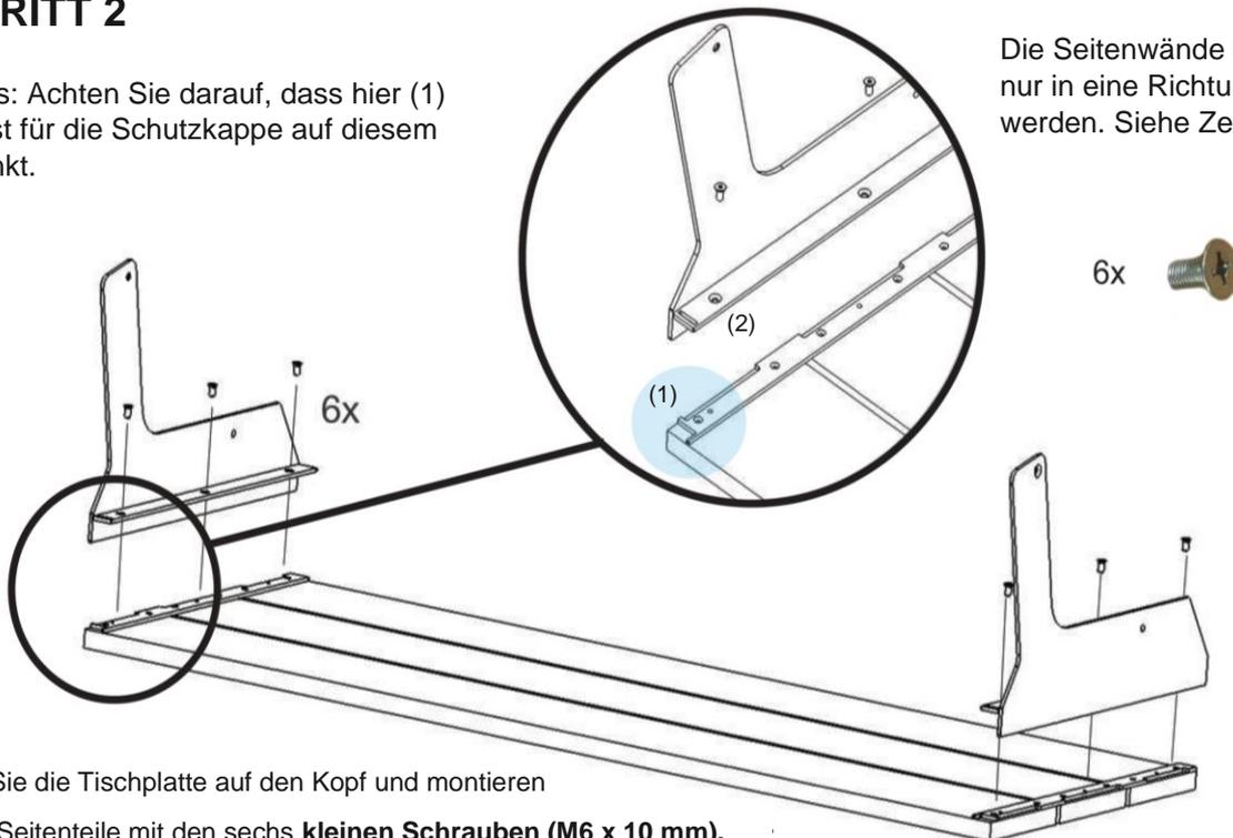
Legen Sie die Tischplatte auf den Kopf und montieren Sie die Seitenteile mit den sechs **kleinen Schrauben (M6 x 10 mm)**.
