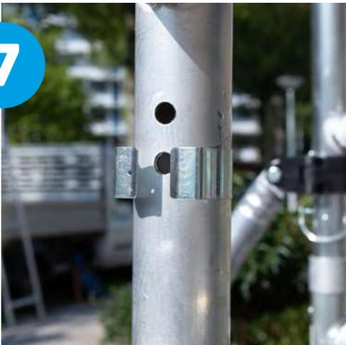
Die nächsten Aufbauteile montieren und diese mit den Sicherungsclips koppeln
