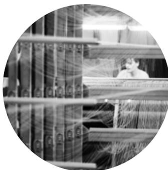
Pour compenser, entre autres, les fluctuations climatiques, différentes récoltes sont mélangées avant que les fibres ne soient transformées en un seul fil. Le fil est d'abord disposé en chaîne puis calibré dans un bain d'amidon pour qu'il ne se casse pas sur les métiers à tisser.
