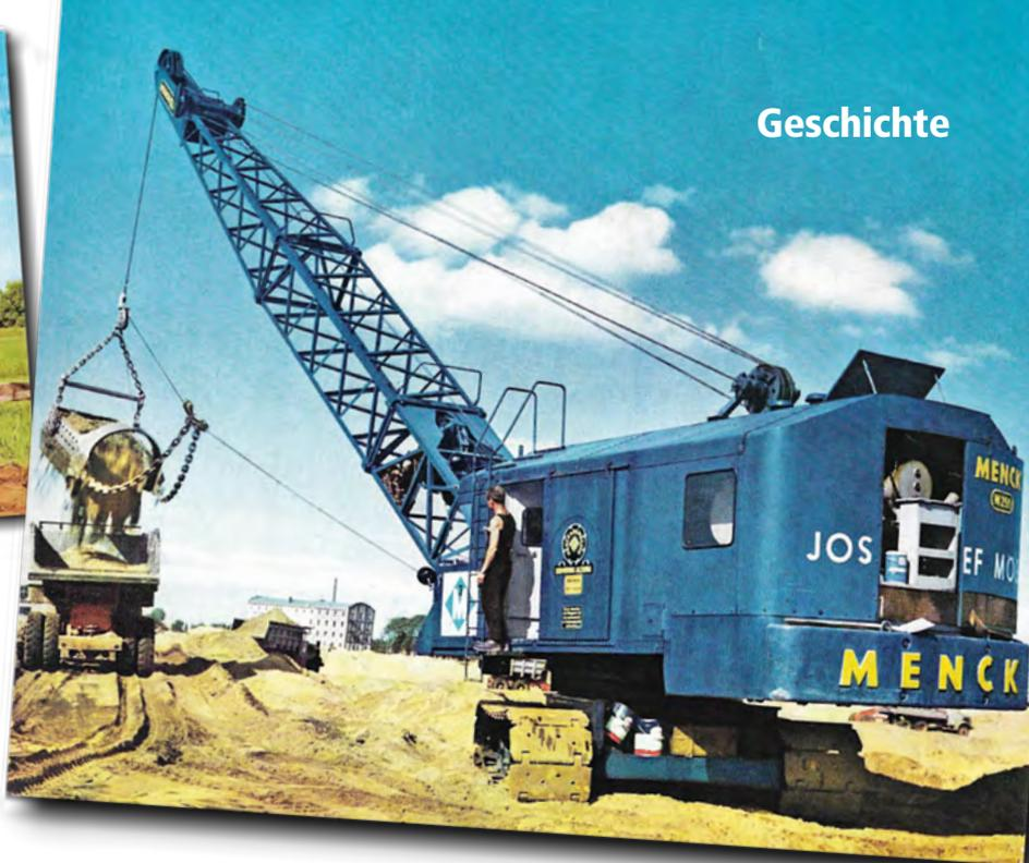
Rechts: Einen Muldenkipper nach dem anderen konnte der geübte Fahrer dieses M 251 mit dem «Record-Eimer» üppig beladen. Damit alles «wie am Schnürchen» lief, sorgte noch gelegentlich der zweite Mann für technische Unterstützung. Gut zu erkennen sind die Schmieröl-Reserven auf dem Unterwagen ...
