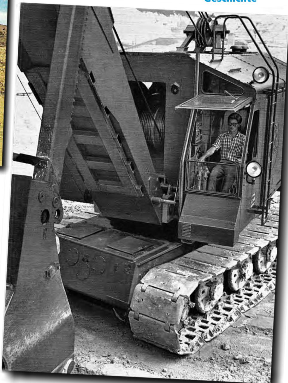
17 m waren durchaus vorgesehen. «Ob alle Baggerleistungen erreicht werden können, hängt von der Art des Bodens und der Geschicklichkeit des Maschinisten ab.», schrieb Menck damals dem Bediener ins Stammbuch. Dieser hatte zumindest durch das getrennte Wendegetriebe, welches ihm das Fahren sowie die Dreh- und Auslegerbewegungen unabhängig voneinander möglich machte, ausreichend technische Unterstützung.
