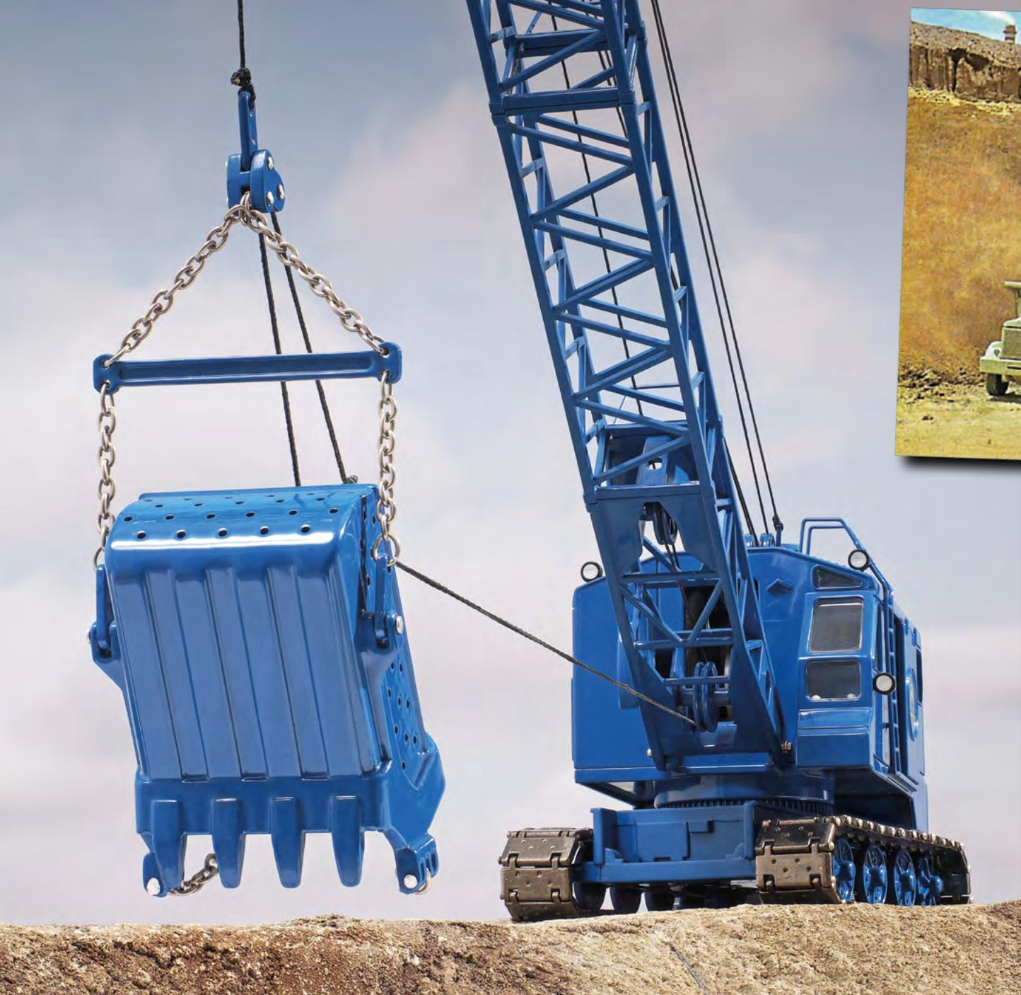
Ober- und Unterwagen durch einen Rollenkranz mit Kippschwelle und beweglichem Mittellager.
