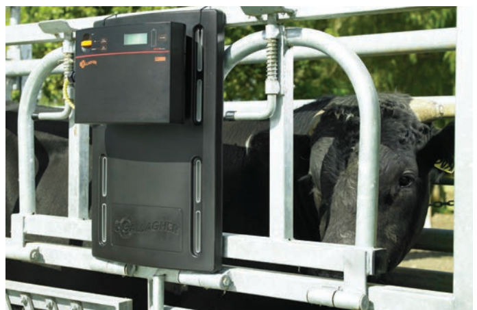
Der BR-Reader liest den Tag des Tieres automatisch ab, sobald das Tier im Wiegekäfig steht.
