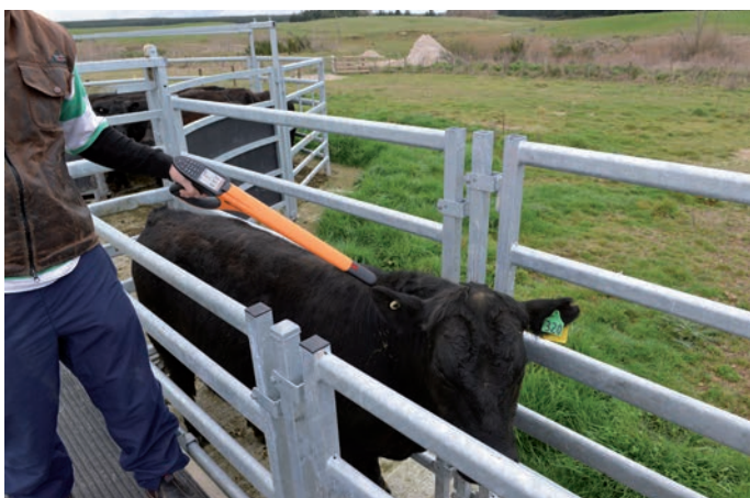
Das HR5 liest den Tag des Tieres ab und zeigt die visuelle ID deutlich auf dem Bildschirm an.
