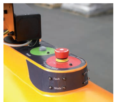
Klar lesbare Anzeige - Mit Notstopptaste, Automatik/manuellem Status und Störungsanzeigelämpchen.
