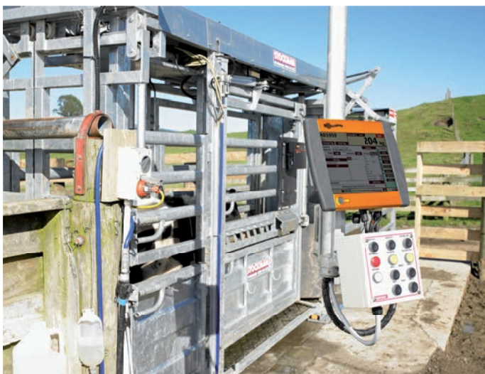
Das TS2 wiegt das Vieh und erfasst Daten zur Verbesserung der Nutztierhaltung
