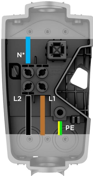
\*Wenn Sie eine Verbindung mit einer 230-V-Deltaschaltung ohne Neutralleiter herstellen, verbinden Sie eine der Phasen mit dem Neutralanschluss der Wirebox.
