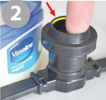
2 Tragen Sie mit dem Finger eine dünne Schicht Vaseline auf, um den oberen Teil der Innenseite des Gummidichtringes zu befeuchten (auf dem Bild gelb markiert). Dies erleichtert das Einschrauben der Lampe.
