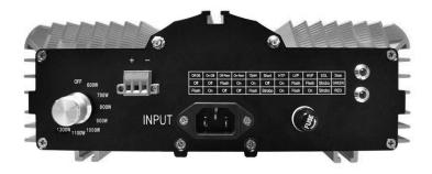
Das alte Vorschaltgerät wird mit 2 Diagnose-LEDs geliefert (1x grün, 1x rot). Die Tabelle neben den LEDs zeigt an, welcher Fehler oder Status vorliegt.
