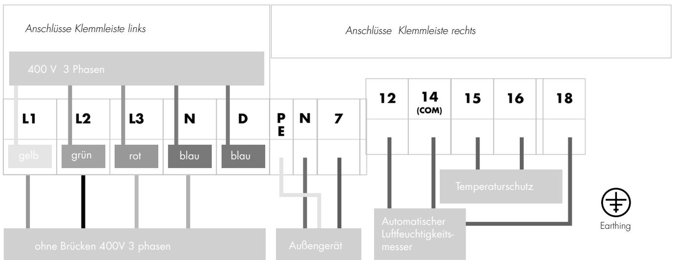
Wird das Inverter Modell mit 3 Phasen an ein 400 V Stromnetz angeschlossen, so werden keine Brücken benötigt. Ebenso wird keine Brücke zwischen N und D benötigt.
