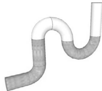
Falsche Verlegung des Kondenswasserabfluss
