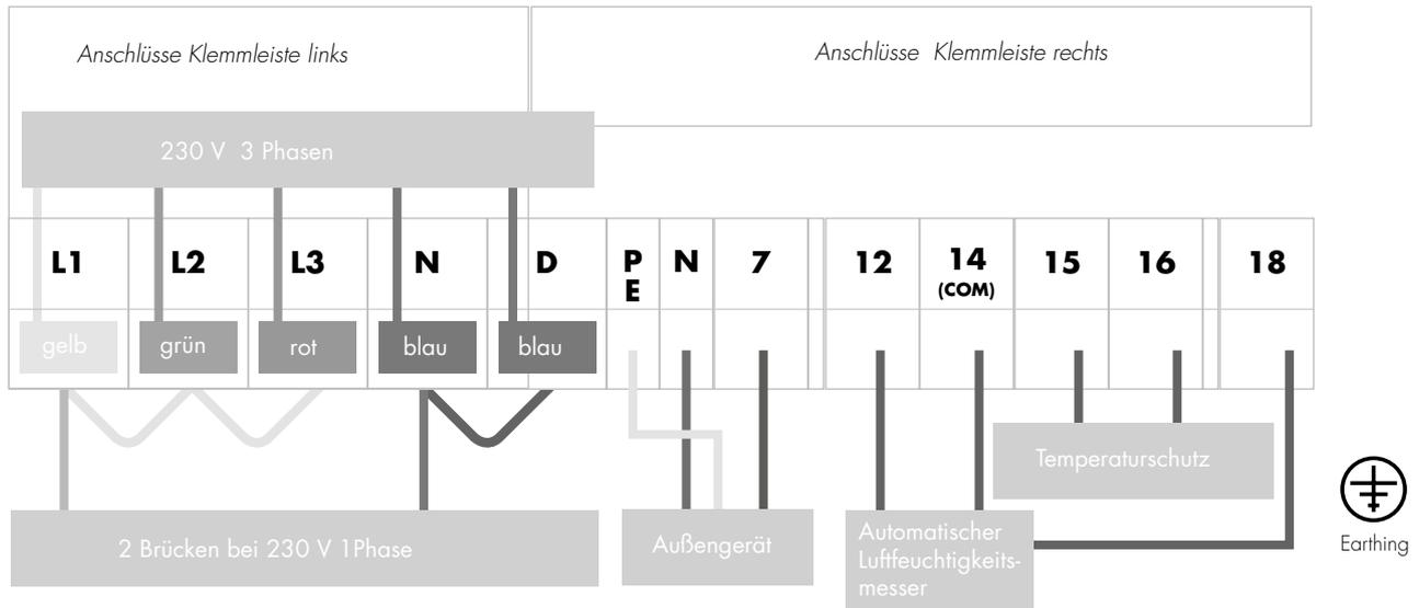
Wird das Inverter Modell an ein 230 V Stromnetz angeschlossen, so klemmen Sie die eine Phase an den Anschluss L1 an. Zwischen L1, L2 und L3 muss eine Brücke eingeklemmt werden. Ebenso wird eine Brücke zwischen N und D benötigt. Bei den neuen OptiClimate-Geräten sind diese Brücken bereits vorhanden.
