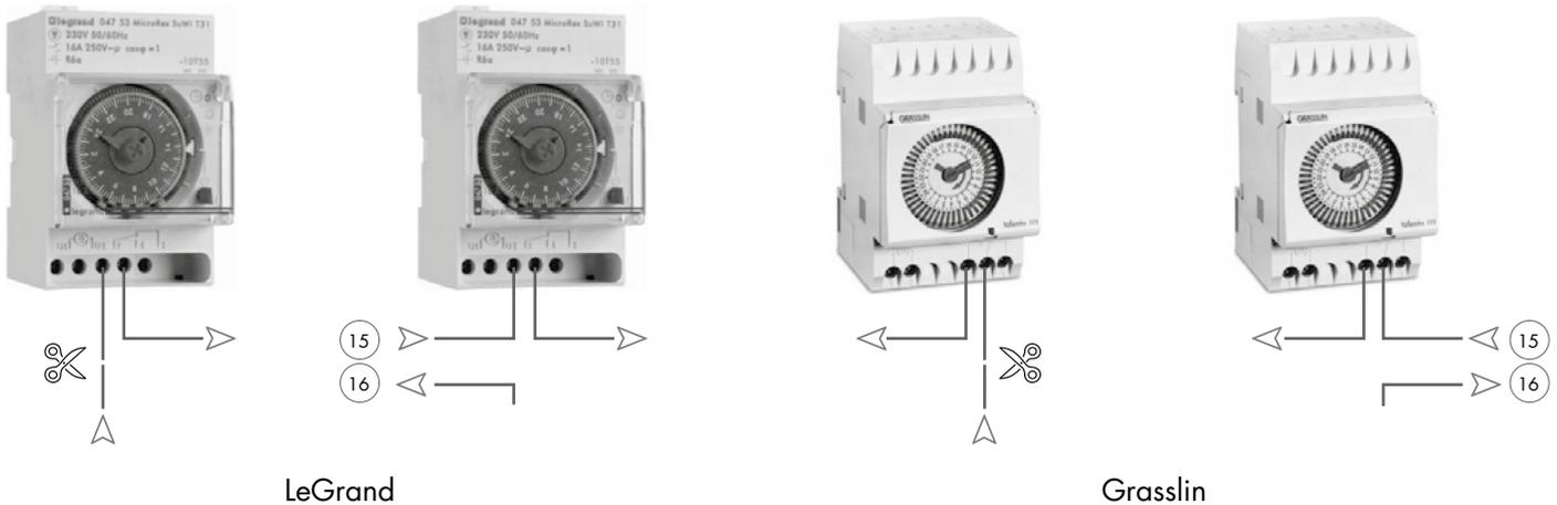
Die zwei Enden sollten mit Anschlussklemmen 15 & 16 auf der Klemmleiste im Elektrofach der OptiClimate verbunden werden. Der Timer wird von der OptiClimate gespeist.
