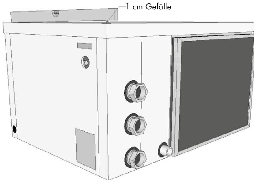
Um das Abfließen des Kondenswassers gewährleisten zu können, muss die Anlage so montiert werden, dass die Seite mit dem Kondenswasserablauf 1 cm tiefer liegt als die gegenüberliegende. Die Halterungen der Anlage sind bereits so vormontiert, dass dieses Gefälle vorhanden ist. Kontrollieren Sie dieses vorsichtshalber nochmal nach der Montage mit Hilfe einer Wasserwaage.
