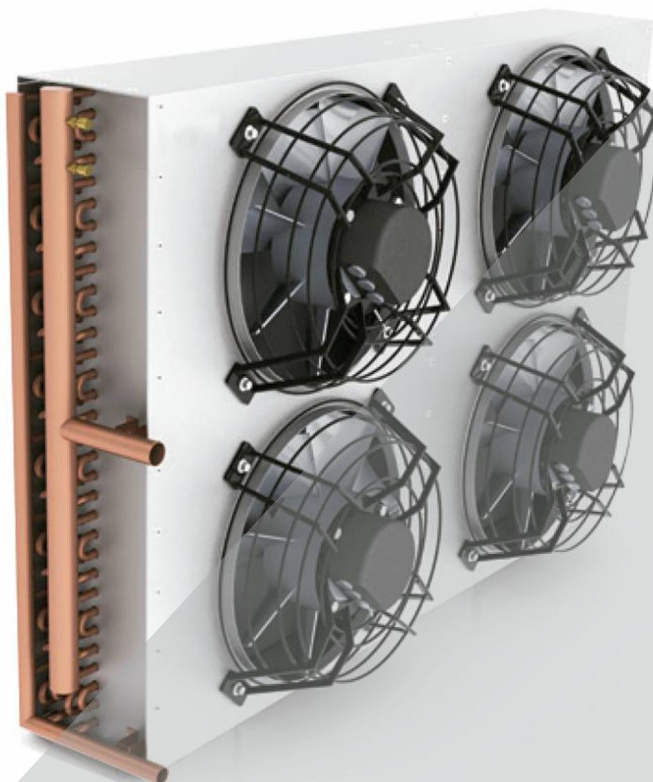
Un ou plusieurs climatiseurs Opticlimate peuvent être connectés à un refroidisseur d'eau. Le refroidisseur d'eau est un moyen très efficace de faire recirculer l'eau ou un mélange de glycol dans un système en circuit fermé. Le(s) ventilateur(s) et la pompe de circulation sont les seules parties qui consomment de l'énergie. Le refroidisseur d'eau permet de préparer de l'eau pour les Opticlimate à des températures extérieures de plus de 40°C\*.
