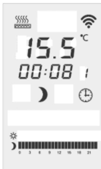
**Uren instellen:** Om de uren in te stellen, druk je kort op de modusknop (menuknop). Druk vervolgens op ▲ of ▼ knop om de minuten in te stellen binnen het bereik van 0–23 uur, in stappen van 1 uur. Na 30 seconden zonder invoer wordt de instelling automatisch beëindigd en schakelt het display door naar de minuut instellingen.
