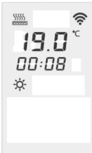
**Mode Eco** : Appuyez brièvement sur le bouton de mode (bouton de menu) pour passer en mode éco. La température standard est de 15,5 °C. Pour régler la température ambiante, appuyez et relâchez le bouton ▲ ou ▼. (pas de 0,5 °C) L'icône de chauffage est allumée lors du chauffage ; sinon non visible.
