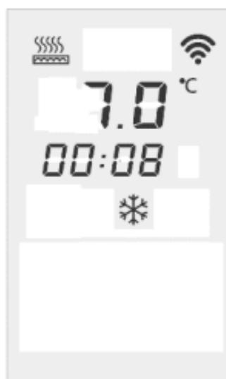
**Tijdfunctiemodus (timermode):** Druk kort op de modusknop (menuknop) om naar de tijdfunctiemodus te schakelen. Bij eerste gebruik verschijnen 4 nullen. Lang indrukken (3 sec) om timer-instelling te openen. Kort indrukken wisselt: uur → minuut → week → afsluiten.
