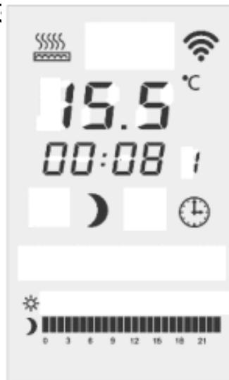
**Stunden einstellen:** Um die Stunden einzustellen, drücken Sie kurz die Modustaste (Menütaste). Drücken Sie dann die Taste ▲ oder ▼, um die Minuten im Bereich von 0 bis 23 Stunden in Schritten von 1 Stunde einzustellen. Nach 30 Sekunden ohne Eingabe endet die Einstellung automatisch und die Anzeige wechselt zur nächsten Einstellung.
