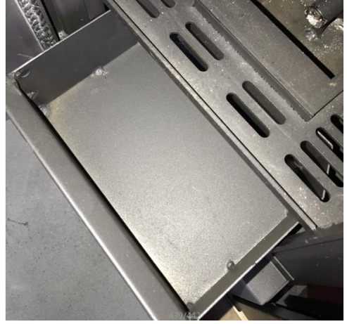
Beispiel für einen verschmutzten Aschenkasten Beispiel für einen sauberen Boden
