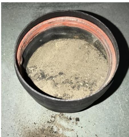
Voorbeeld van een vuile afdekking
