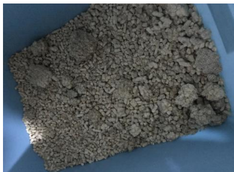
Cuisson Granulés de mauvaise qualité
