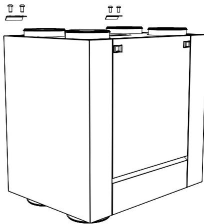
Collez les butées sur l'unité de ventilation avant de fixer l'unité de ventilation au mur.
