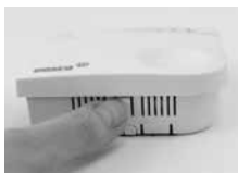
Étape 1: Démontez le sélecteur. Étape 2: Marquez l'emplacement des trous de vis de la plaque de base sur le mur.
