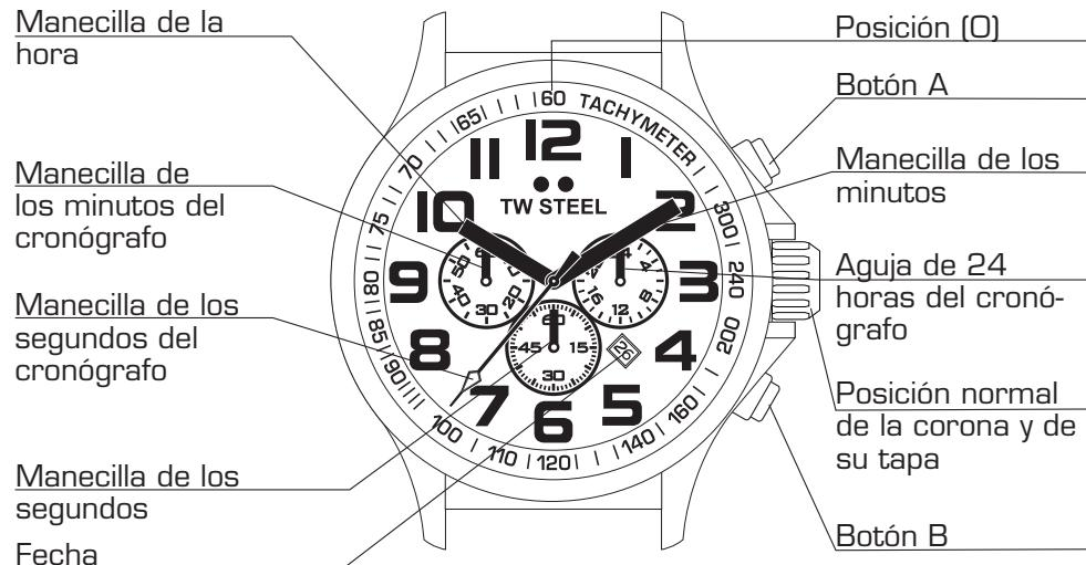
Las manecillas del cronógrafo se pueden avanzar rápidamente pulsando continuamente el botón A. Una vez que la manecilla de los segundos del cronógrafo haya vuelto a la posición (0), coloque la corona de nuevo en su posición normal.
