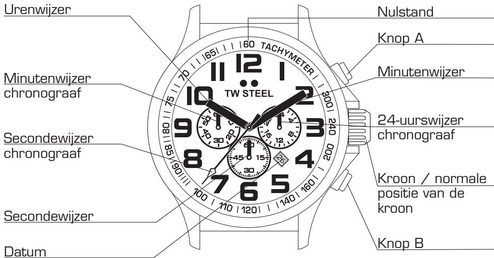
De secondewijzer van de chronograaf kan snel worden rondgedraaid door knop A ingedrukt te houden. Zodra de secondewijzer van de chronograaf naar de nulstand is teruggekeerd, duwt u de kroon in zijn normale stand terug.
