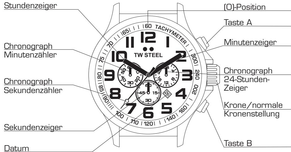
Position zurückkehrt, sollten Sie Folgendes tun: Ziehen Sie die Krone bis zur zweiten Position heraus. Drücken Sie die Taste A, um den Sekundenzeiger in die Position (0) zu stellen. Die Zeiger des Chronographen können schneller bewegt werden, indem Sie die Taste A eingedrückt halten. Sobald sich der Sekundenzeiger des Chronographen wieder in der (0)-Position befindet, drücken Sie die Krone in ihre ursprüngliche Position zurück.
