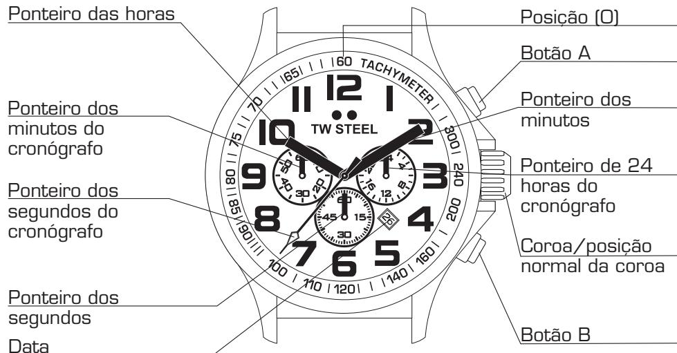
Pode fazer avançar rapidamente os ponteiros do cronógrafo carregando sem soltar o botão A. Quando o ponteiro dos segundos do cronógrafo voltar à posição (0), volte a empurrar a coroa para a sua posição normal.
