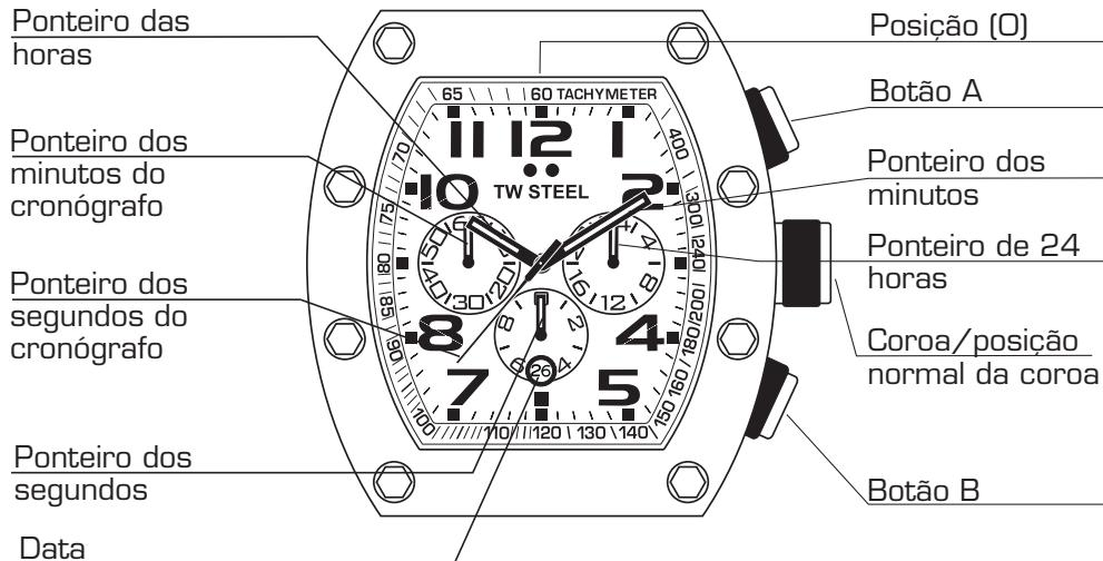
Todos os ponteiros voltam então à posição (0). Se carregar novamente no botão B, volta a pôr o ponteiro dos segundos a andar.
