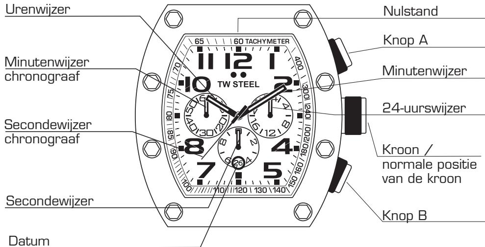
Als de secondewijzer en de 1/20e-secondewijzer van de chronograaf niet naar de nulstand terugkeren nadat de chronograaf is gereset of de batterij is vervangen, moet u het volgende doen: Trek de kroon er tot de 2e stand uit. Druk op knop A om de secondewijzer van de chronograaf in de nulstand te zetten.
