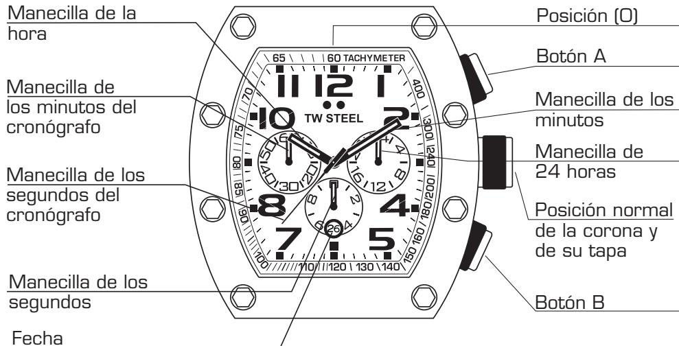
del cronógrafo no vuelven a la posición (0) una vez reiniciado el cronógrafo o sustituida la pila, haga lo siguiente: tire de la corona hasta la 2<sup>a</sup> posición. Pulse el botón A para ajustar la manecilla de los segundos del cronógrafo en la posición (0).
