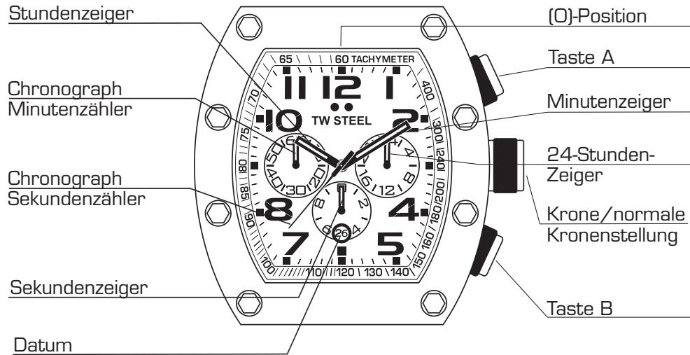
Alle Zeiger kehren dann zur (0)-Position zurück. Der Sekundenzeiger kann durch nochmaliges Drücken der Taste B neu gestartet werden.
