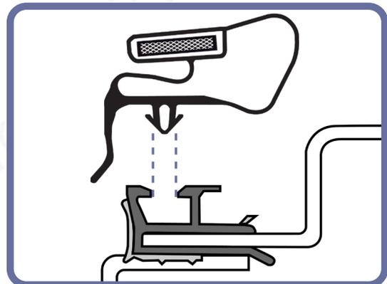
Den Dichtungsrahmen in die Nut drücken.
