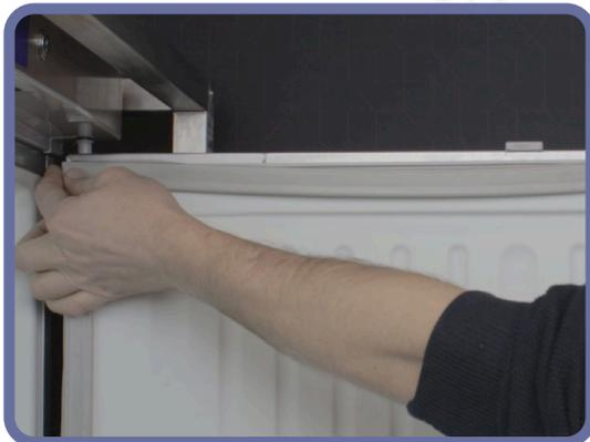
In den Ecken beginnen und den Dichtungsrahmen gleichmäßig von den Ecken bis in die Mitte in die Nut drücken.
