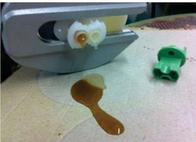
Tragen Sie etwas Material ohne die Mischerspitze aus, um die Position der Kolben anzugleichen.
