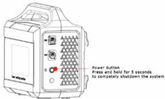
Abschaltbetrieb von Lasern der L-Serie
