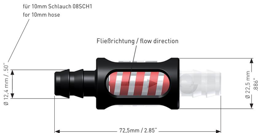
Die Montage der Einzelteile erfolgt ausschließlich durch formschlüssige Rastung – keine Klebe- oder Schweißstellen. Nach normalem Gebrauch ist der Fließanzeiger in seine Einzelteile zerlegbar und somit, soweit es die technischen Kunststoffe zulassen, 100% recycelbar. All parts are assembled by means snap-in, no glue, no heat seal. All parts can be recycled at end of life cycle.
