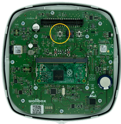
Fig. A.3.1 Inställning av RS485-omkopplaren till "T"
