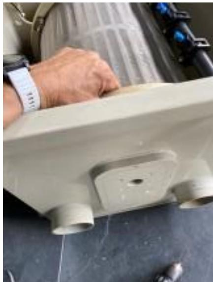
trek de motor met de as uit het filter
