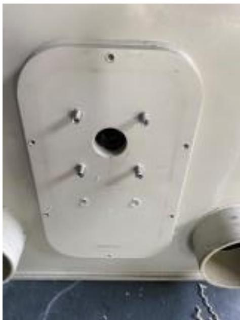
U kunt de draadeindjes (die zijn meegeleverd) met een inbus (met een accu schroefboormachine) vastdraaien. Druk goed aan en draai vervolgens vast tot een diepte van 12 mm (lage toeren)
