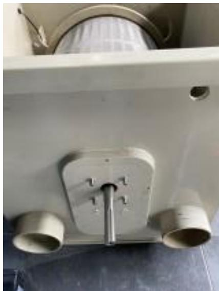
Nu kunt u de RVS as monteren. Plaats de roestvrijstalen as (let op de afdichting) en draai vervolgens links om vast in de trommel. Dit is een linkse draad ipv een rechtse draad. Dus de motor draait link om.
