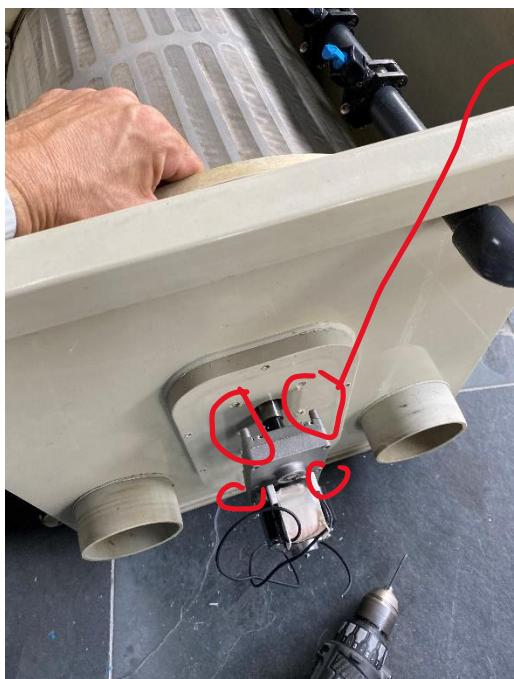
Draai de inbus baten los van de motor.
