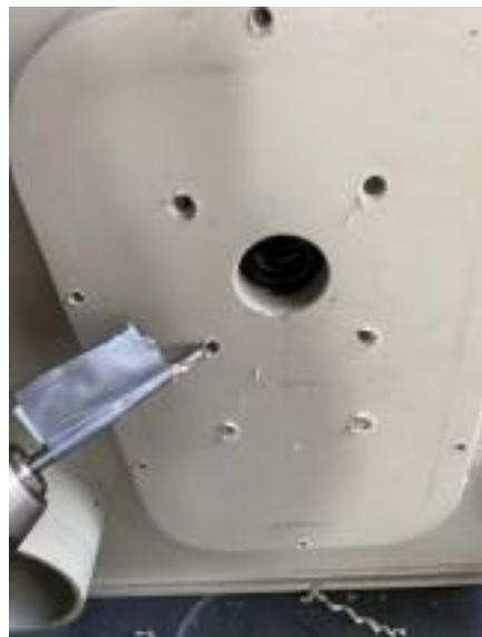
Sie können die Bolzen mit einem Innensechskant am Elektroschrauber eindrehen. Gut andrücken und dann auf 12 mm Tiefe festziehen. Maximal 12 mm tief! Der äußere Teil ist etwa 13 mm Sie können die Bolzen mit einem Innensechskant am Elektroschrauber eindrehen. Gut andrücken und dann auf 12 mm Tiefe festziehen.
