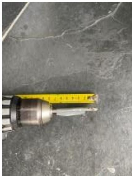
Bohren Sie dann mit einem Bohrer 6,5 Löcher für die Stehbolzen. Bohren max 12mm tief !!!!
