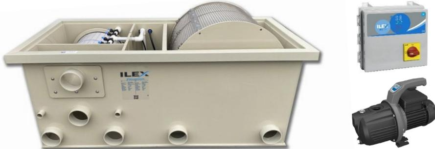
Der RBC ist ein rotierendes Rieselfilterkonzept, bei dem keine Förderhöhe von der Pumpe benötigt wird! Der RBC liegt 40% unter Wasser und 60% über Wasser für maximale Sauerstoffsättigung. Das große Geheimnis dieses Designs ist, dass Sauerstoff bis zu 4% \* in Wasser und 20% in Luft enthalten kann. Dies gibt den Teichbakterien die besten Bedingungen, um ihre Arbeit effizient auszuführen.
