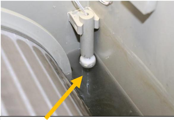
Le flotteur est en position « rinçage », la pompe du bassin est en marche. Le tambour tourne et la pompe de rinçage rince le tissu. Si le flotteur reste dans cette position pendant 30 secondes, l'électronique passe en MODE DE FONCTIONNEMENT À SEC.
