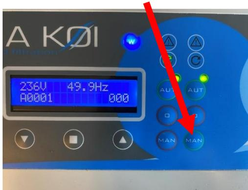
En maintenant ce bouton enfoncé, la pompe d'étang s'arrêtera et le moteur et la pompe de rinçage sera activée. Le fait de le relâcher à nouveau éteint le système. Appuyez ensuite à nouveau sur les boutons AUT (le voyant vert s'allumera à nouveau) pour réactiver le système (la pompe de l'étang s'allumera à nouveau).
