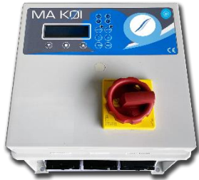
Makoi Pondfiltration controller
