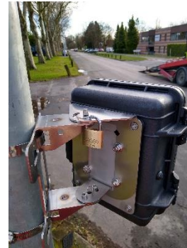
Figuur 21: klemschroef voor -45° en optionele slot
