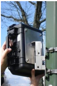
Figuur 8: drager + achterzijde radar
