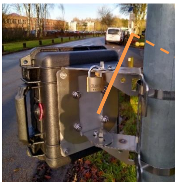
Figuur 22: klemschroef voor een andere hoek dan 45°
