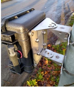
Figuur 12: TMS-SA op zijn draagstuk
