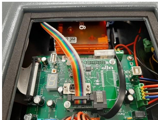
Figuur 15: modem in de I-SAFE behuizing geslepen
