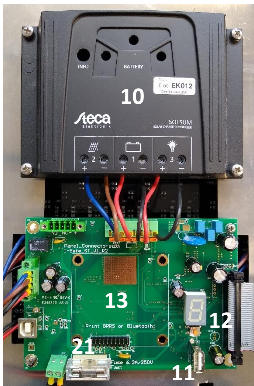
Figuur 5: zonneregelaar en configuratiebord
